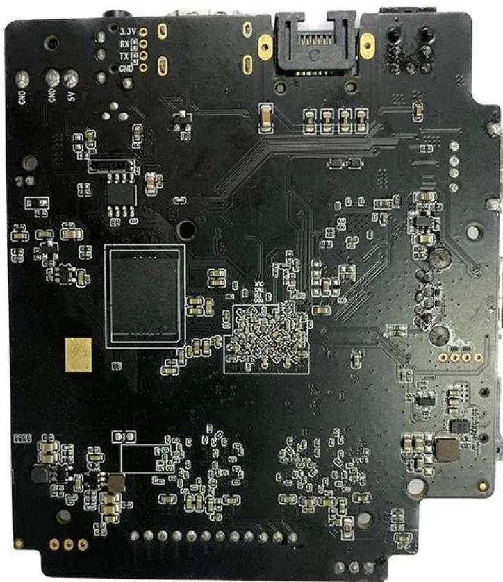
Amlogic S928X — это первая интеллектуальная SoC-приставка с разрешением 8K UHD, объединяющая ARM Cortex-A76, ARM Cortex-A55 и процессор нейронной сети собственной разработки. Он поддерживает функцию декодирования видео 8Кр60 для основных мировых видеоформатов — AV1, H.265, VP9, AVS3, AVS2 и т. д. Между тем, графический интерфейс 4K, интеллектуальный SR и другие функции также жизнеспособны, что обеспечивает выдающийся аппаратный механизм для настройки высококлассные приложения.
